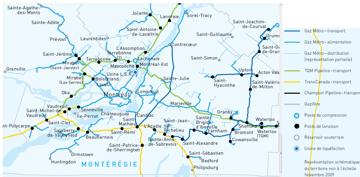
Figure 40 : Réseau de transport et d'alimentation de gaz naturel au Québec, zoom sur la Montérégie
